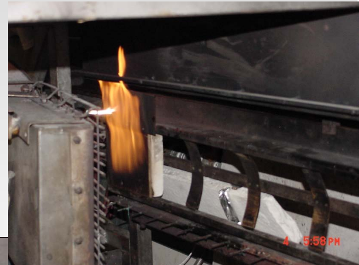
ASTM E1321 ignition test
